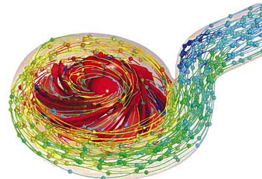
De ontwikkelafdeling van Munsch maakt intensief gebruik van CFD (Computer Fluid Dynamics). In dit geval gaat het met name om verdere efficiency verbeteringen
