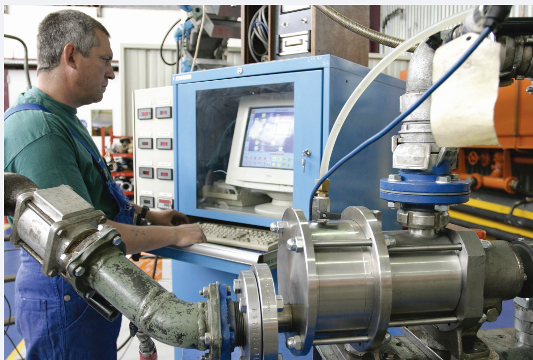
MOUVEX-Blackmer test alle pompen voordat ze de fabriek verlaten
