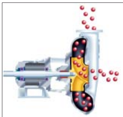
Afb. 3b Werking van éénkanaalwaaier centrifugaalpom
